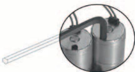
Simplement serrer les vannes sur l'embase en utilisant une clé Allen de 3 mm (couple de serrage de 0,45 à 1,1 Nm, ne pas forcer lors du serrage)
